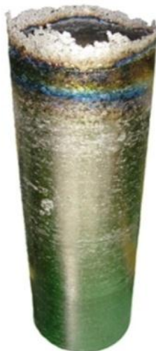
Рисунок 19 – Внешний вид слитка гафния марки ГФЭ-1 диаметром 320 мм, выплавленного двукратным вакуумно-дуговым переплавом
