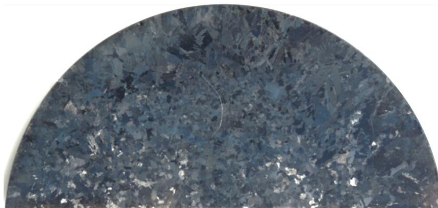
Рисунок 18 – Макроструктура верхней части слитка диаметром 320 мм двукратного вакуумно-дугового перепада, выплавленного с применением оптимизированного режима выведения усадочной раковины
