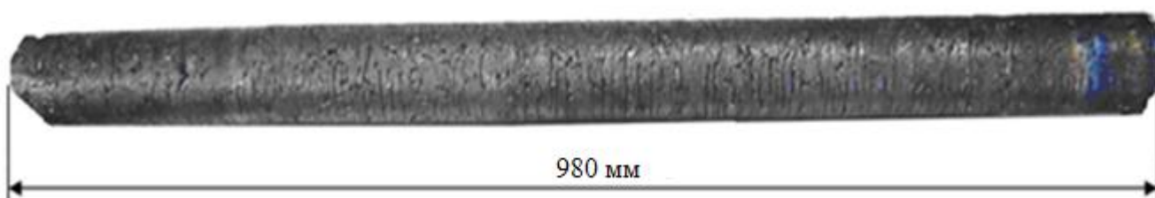
Рисунок 23 – Внешний вид слитка гафния из оборотов 1-3 класса, выплавленного в электронно-лучевой печи с промежуточной емкостью, диаметром 75 мм
